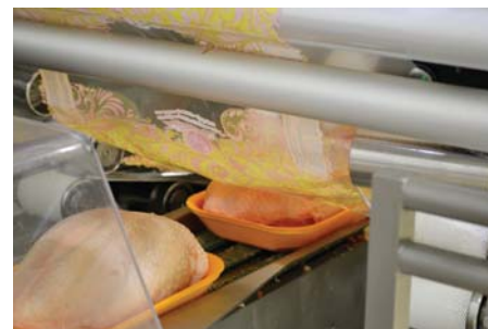
Упаковочная система на базе PACIFIC SSF предполагает упаковку мяса птицы в лотке и является сочетанием трех элементов: горизонтальный флоупак, стретч-упаковка, термоусадка
