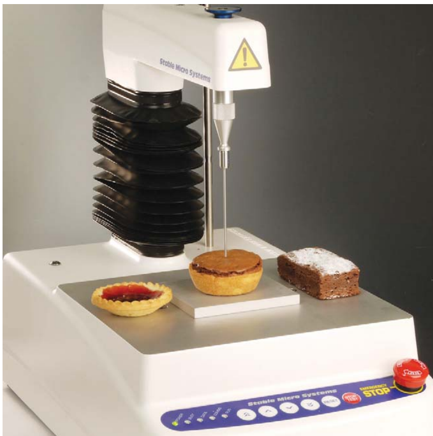
Тестирование текстуры тауни с TA.XT Texture Analyser
