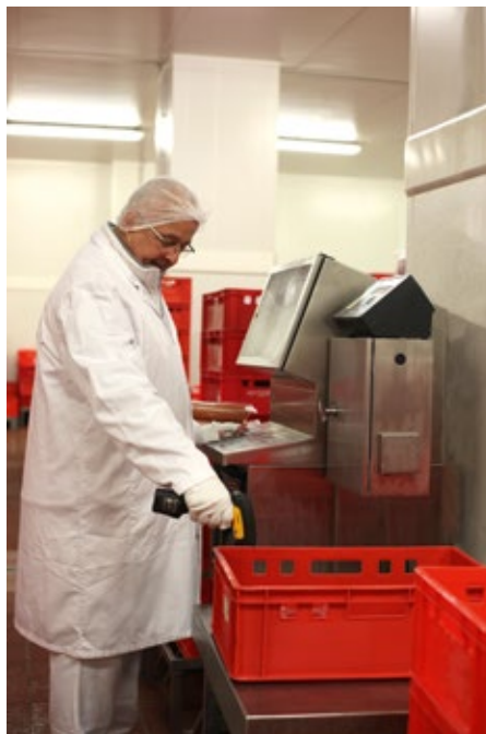
В процессе комплектации заказов артикулы регистрируются с помощью мобильных терминалов для сбора данных и автоматически передаются в ERP-систему, включая все данные по прослеживанию.
