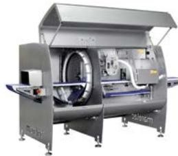
Marelec PORTIO – машина для порционной нарезки с фиксированным весом бескостного мяса, мясных деликатесов и колбас.
