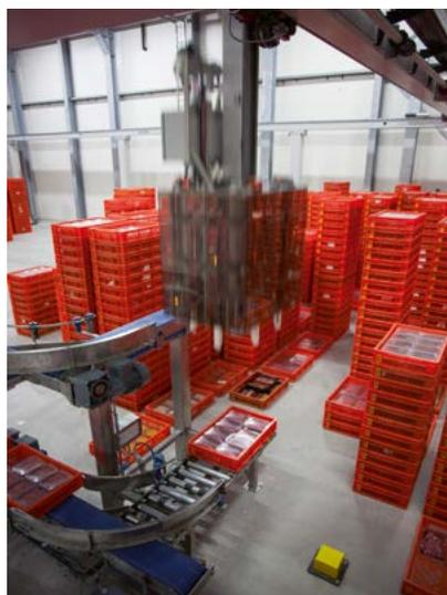
*Управляемые с помощью CSB-System портальные роботы могут загружать и отгружать одновременно до 7 ящиков*
