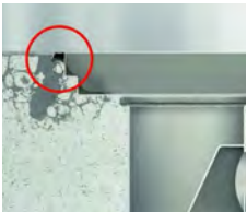
Рисунок 1. Уплотнение под кантом трапа Кант с уплотнением Кант без уплотнения
