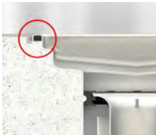
Рисунок 1. Уплотнение под кантом трапа Кант с уплотнением Кант без уплотнения
