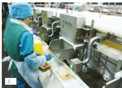
2. Оператор нажимает на кнопку и точно взвешенная порция выпадает из бункера.
