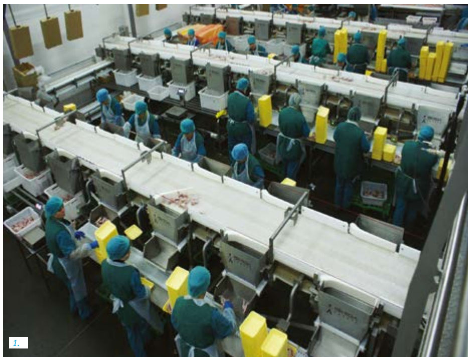
1. На станциях сортировки весового дозатора компании Ishida восемь сотрудников могут спокойно работать с поступающей продукцией при скорости разделки 10 500 тушек в час. Остальные восемь станций позволят увеличить мощности в будущем.
