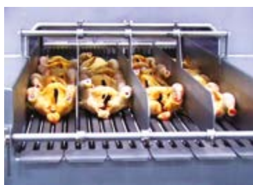
Специальные инъекторы Inject Star для мяса птицы позволяют производить однородную инъекцию курицы целиком или частями, с костями или без костей.
