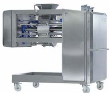
MIDOS формирует однородное тестовое полотно необходимой ширины и толщины, что обеспечивает точность по весу.
