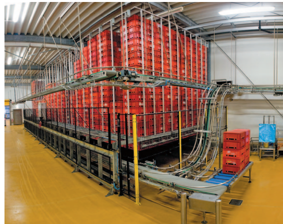
Автоматизированный склад пустой тары фирмы WVG-Kainz
