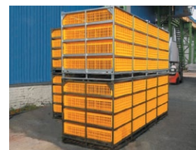
Контейнер тип 4 Габариты 2460×1015×1348 мм Грузоподъемность – до 800 кг
