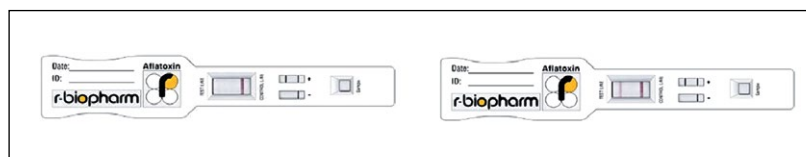
Рис. 1. Тест-полоски RIDA®QUICK Afatoxin (слева – содержание афлатоксина в зерне менее 4 мкг/кг, справа – около 5 мкг/кг)
