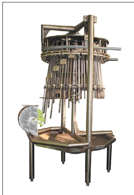
Рис. 3. Машина отделения зоба, трахеи и пищевода
