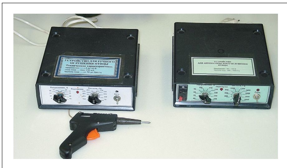
Рис. 2. Аппараты для ручного и автоматического оглушения птицы
