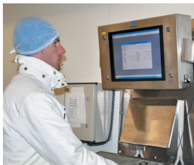
С многофункциональным промышленным компьютером (MF-CSB-Rack) комплектация заказов, взвешивание и маркировка сводятся в единый рабочий шаг.
