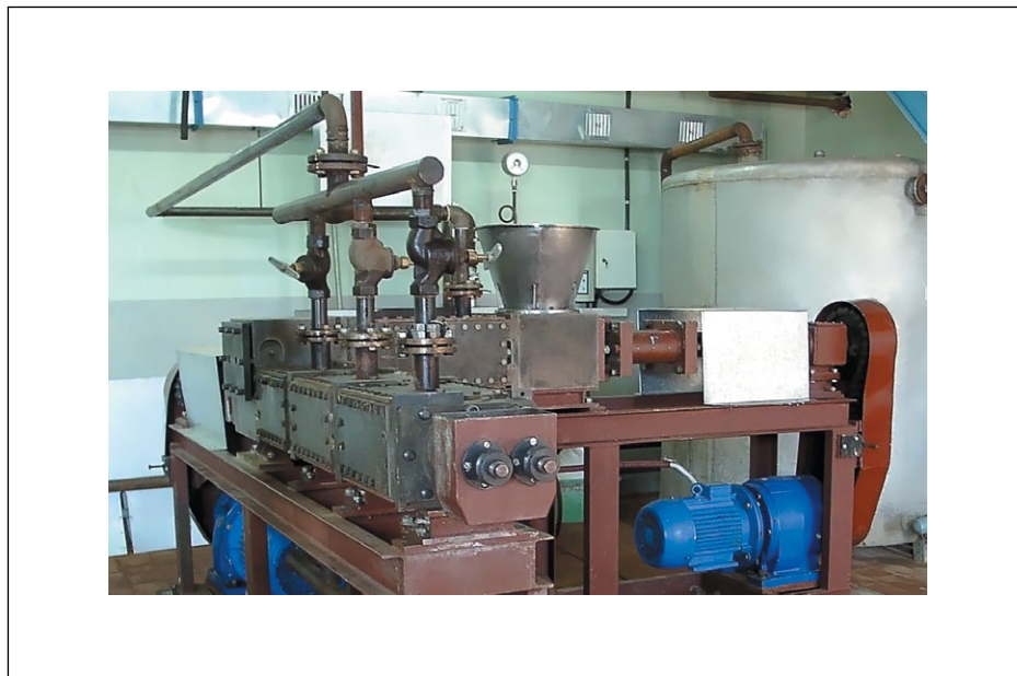
Фото 1. Серийный образец гидролизера для высокотемпературной кратковременной обработки (производительность 500 кг влажного пера в час или 250 кг сухого пера в час)
