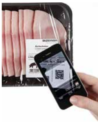
Рис. 3. Этикетка с QR-кодом. За последние несколько лет во многих странах мира стала востребованной технология кодов быстрого отклика. При их фотографировании мобильными устройствами пользователь автоматически переадресовывается на интернет-ресурс производителя товара.
