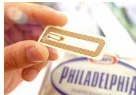
Рис. 2. RFID-этикетки с радиочастотной идентификацией позволяют кодировать различную информацию в электронном виде и считывать автоматически специальным устройством. Метки RFID могут хранить до 1000 бит информации.
