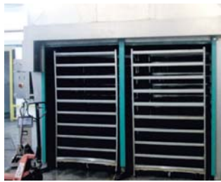
Современные воздушно-капельные дефростеры позволяют выбрать скорость циркуляции воздуха в камере в зависимости от того, какой продукт необходимо разморозить.
