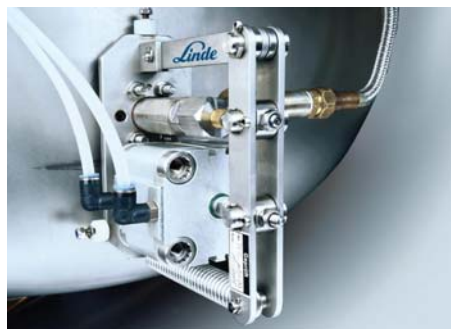
Пример установки системы подачи жидкого газа на фаршемешалках.
