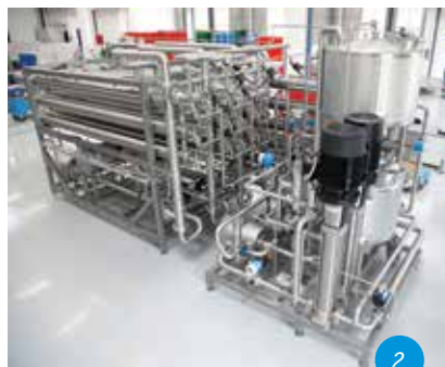
1. Установка микрофильтрации Кизельманн 2. Установка нанофильтрации Кизельманн для сгущения творожной сыворотки
