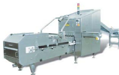
Производительность оборудования для разбивания яиц зависит от типа выбранной установки и может составлять до 20 тыс. штук в час
