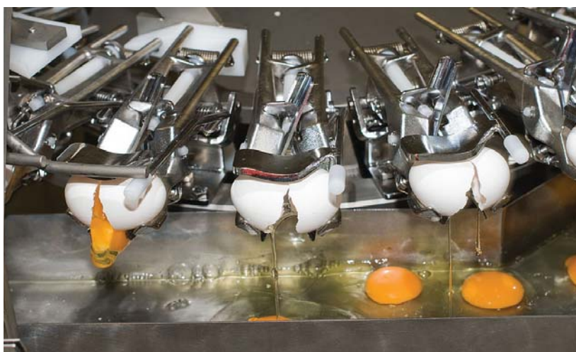
Самые современные образцы машин для разбивания яиц могут самостоятельно отделять белок от желтка, значительно экономя время
