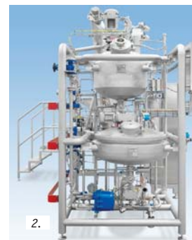
1. Линия CHOCOFORM® предназначена для изготовления изделий из шоколада различной формы 2. ECOGRAV® – экономия энергии до 50% при приготовлении сахаропаточных сиропов
