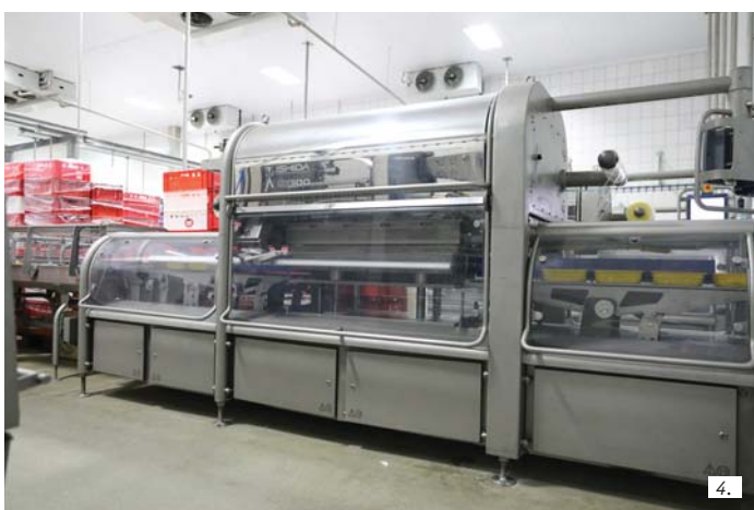
1–3. Оператор нажимает на кнопку, и точно взвешенная порция выпадает из бункера. Оператор выкладывает кусочки порции на подложку и размещает ее на конвейер для дальнейшей запайки и маркировки 4. Трейсилеры Ishida QX-1100 позволили предложить покупателям широкий ассортимент лотков разных размеров и типов, с различными видами пленки, а также используемой МГС 5–7. Совместное использование систем рентгеновского контроля Ishida и тестеров качества запайки лотков обеспечивают стабильно высокое качество продукции
