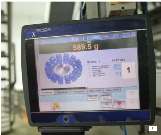
2-4. Весовой дозатор точно формирует заданные порции, которые затем сбрасываются на дозировочный стол для ручной укладки в лотки операторами
