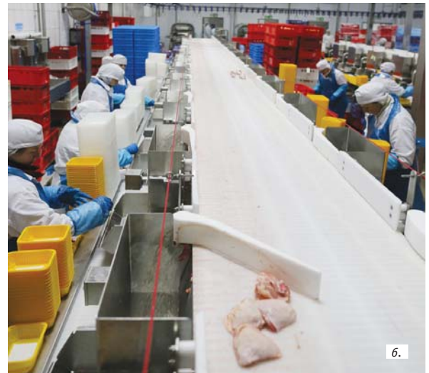
5, 6. Конвейеры, куда поступает мясо после мультиголовочного дозатора, подают взвешенный продукт на рабочие станции. Как только взвешенная порция поступает на рабочую станцию, рычаг сталкивает продукт с конвейера на уровень станции для дальнейшей ручной укладки в лотки операторами
