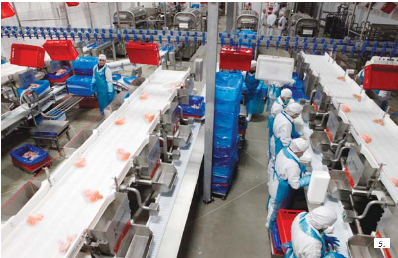
5, 6. Конвейеры, куда поступает мясо после мультиголовочного дозатора, подают взвешенный продукт на рабочие станции. Как только взвешенная порция поступает на рабочую станцию, рычаг сталкивает продукт с конвейера на уровень станции для дальнейшей ручной укладки в лотки операторами
