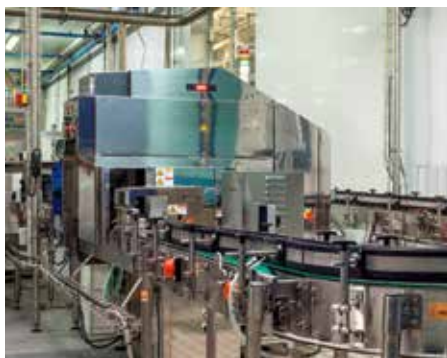
Candia осуществляет контроль качества содержимого 10 миллионов бутылок с молочными смесями для детей в год, используя новую систему рентгеновского контроля Ishida.
