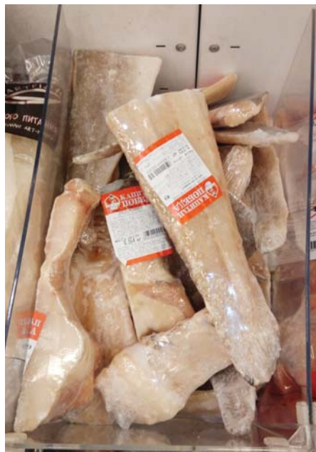
Индивидуальная упаковка порционной замороженной рыбы, сделанная на горизонтальном флоупаке с применением полиолефиновой термоусадочной пленки
