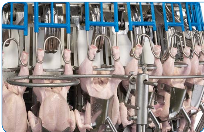
Оборудование по потрошению «БААДЕР LINCO» позволяет проводить удаление потрохов и кишечника эффективно и в щадящем режиме
