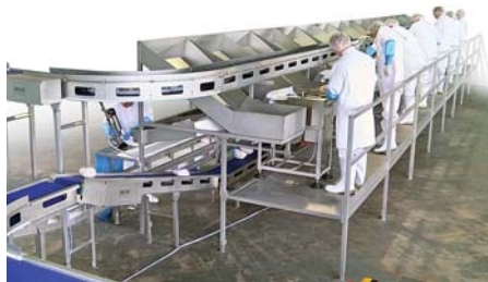
Интегрирование в упаковочные линии в комбинации с оснащенными клипсаторами транспортерами для подачи тушек и транспортерами для отвода готового продукта
