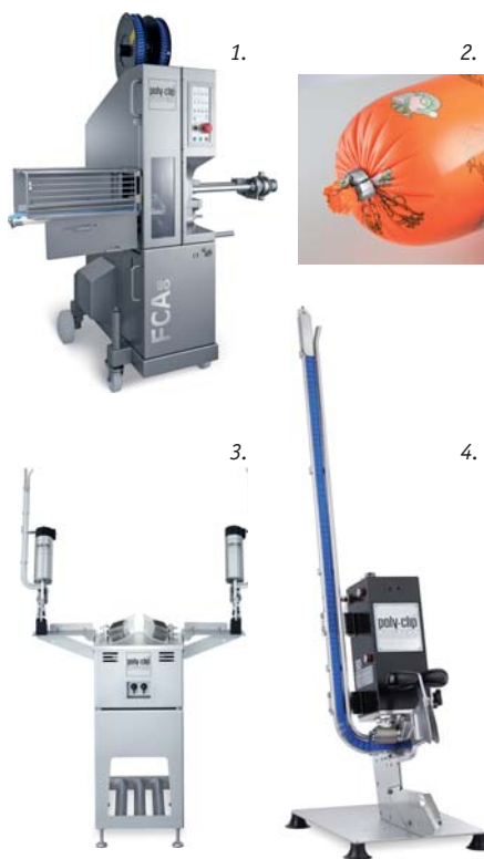
1. Автомат двойного клипсования FCA 80 2. Благодаря вертикальному исполнению фаршевытеснителя у продукта получается красивая «плиссировка» оболочки и чистые хвостики 3. Упаковщик Poly-clip MPL 4. Машина клипсования одной скрепкой SCD
