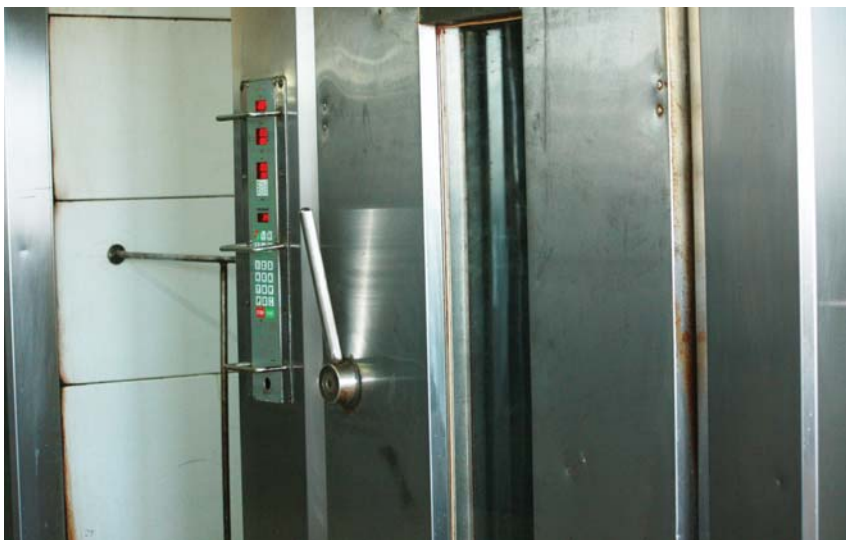
Современные расстоечные шкафы имеют электронную панель управления, при помощи которой задаются режимы для разного вида продукции
