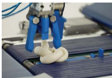
Машина Fritsch MULTITWIST была разработана компанией в 1998 году с целью полностью автоматизировать изготовление плетеных изделий
