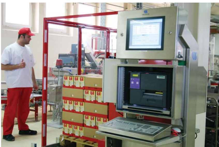
Рабочее место сбора палет с готовой продукцией, оборудованное промышленным компьютером CSB-Rack
