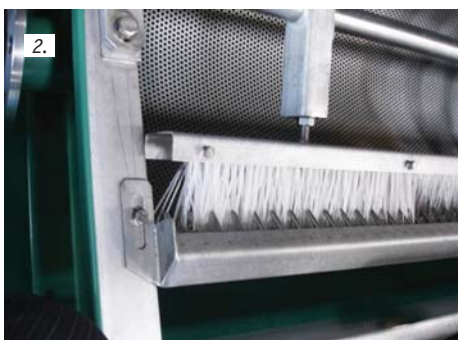
1. Щеточная решетка тонкой очистки производства «Экополимер» 2. Щеточная решетка тонкой очистки производства «Экополимер» 3. Напорный реагентный флотатор UF-80 производства Vodatech
