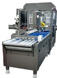
Производительность робота для шашлыка ASR 300 multipick составляет от 200 до 400 кг в час
