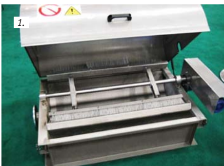
1. Щеточная решетка тонкой очистки производства «Экополимер» 2. Щеточная решетка тонкой очистки производства «Экополимер» 3. Напорный реагентный флотатор UF-80 производства Vodatech
