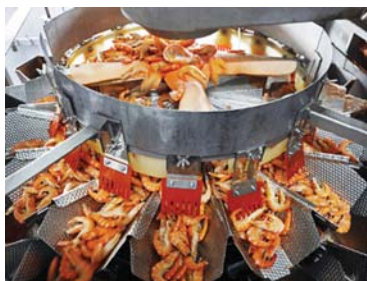
На производстве «Агама Роял Гринланд» работают приобретенные в лизинг линии по автоматической дозации, вакуумной фасовке и упаковке
