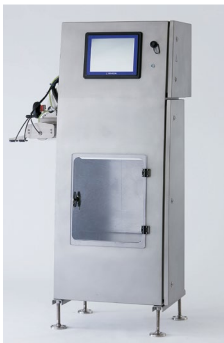
Ishida AirScan использует инновационную лазерную технологию для обнаружения в запаянных упаковках с МГС мест утечки CO 2 из отверстий, не превышающих 0,5 мм в диаметре. При этом скорость работы нового оборудования составляет до 180 упаковок в минуту.
