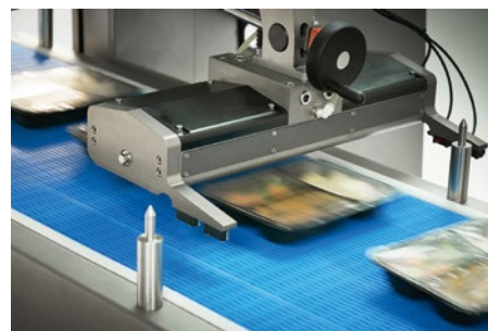
Ishida AirScan использует инновационную лазерную технологию для обнаружения в запаянных упаковках с МГС мест утечки CO 2 из отверстий, не превышающих 0,5 мм в диаметре. При этом скорость работы нового оборудования составляет до 180 упаковок в минуту.
