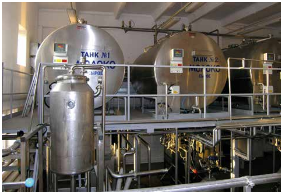
Фото 1. Вертикальная компоновка участка приемки и обработки молока
