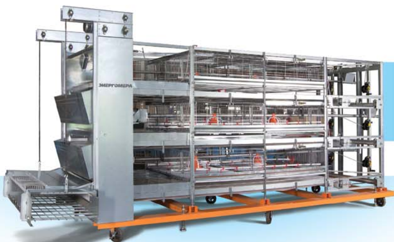
Клеточное оборудование для содержания бройлеров КП-35ВМ с механизированной выгрузкой птицы
