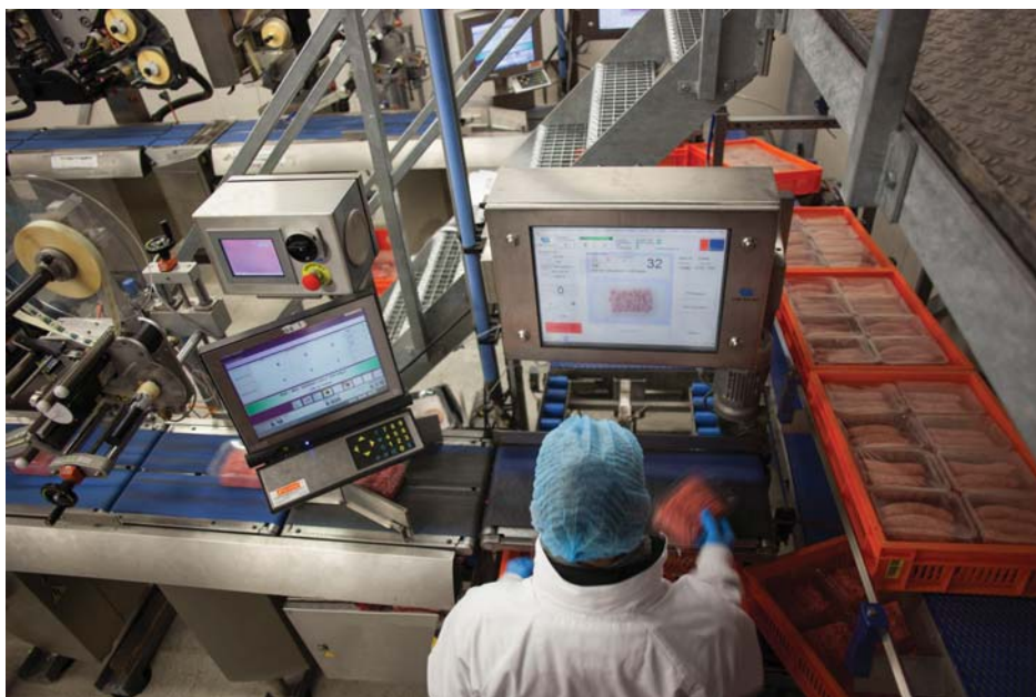
Четыре принтера этикеток с подключенными сортировочными установками могут собирать от 5000 до 7500 единиц упаковок в смешанные ящики
