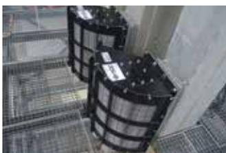
Пламегасители FLEX - устройства для беспламенного снятия давления взрыва на нории.
