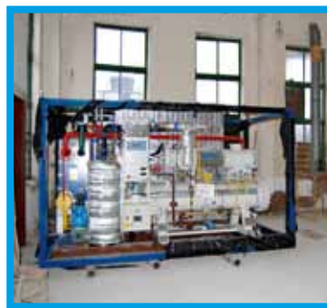
Фото 5. Холодильный блок на основе аддитивного термодинамического цикла
