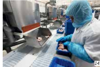
11-14. Точно взвешенная партия продукта сбрасывается на конвейер и укладываются вручную в лотки.
