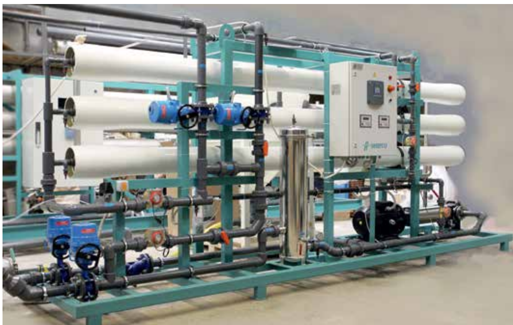
Промышленная обратноосмотическая установка – совместная разработка ООО «Гидротех» и ВНИИПБТ – филиала ФГБНУ «ФИЦ питания и биотехнологии»
