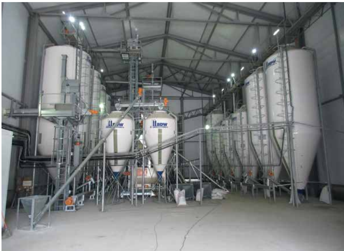
Кормоцех для производства корма для уток 5 т/ч с линий гранулирования
