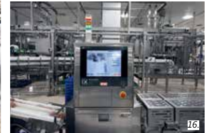
16. Упаковки с куриным филе поступают в систему рентгеновского контроля для обнаружения возможных костных остатков.
