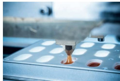
Производственная установка WDS для отливки кондитерских изделий в силиконовые формы
