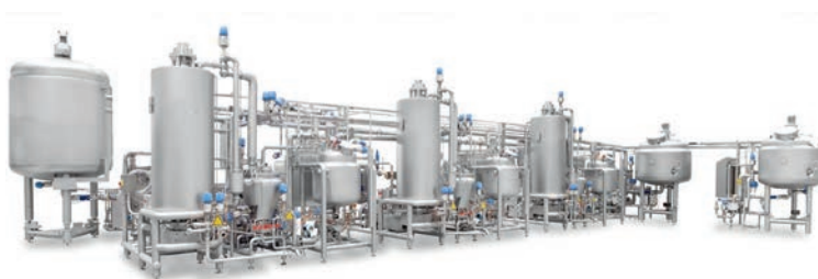
Линия непрерывного действия для изготовления твердой карамели.
