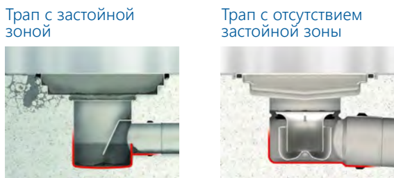
Рисунок 12. Конструкция дна трапа
