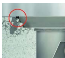
Рисунок 11. Скопление влажной среды в прямом угле
