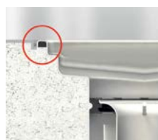
Рисунок 11. Скопление влажной среды в прямом угле
