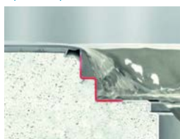
Рисунок 12. Конструкция дна трапа
