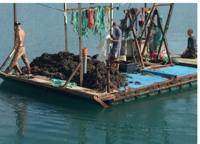
Рисунок 6. Один из вариантов специализированного судна с подвесным двигателем (изготовленном в самом хозяйстве) для обслуживания ГБТС в море
