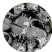
Рисунок 4. Фотография микроструктуры сорбента «Заслон Фито» под электронным микроскопом
