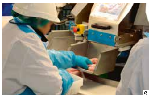
7, 8. После мультиголовочного дозирования взвешенная порция попадает на станцию ручной укладки в лотки.
