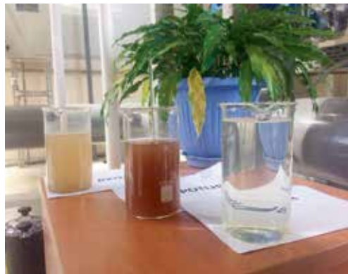
Сточные воды по этапам очистки (слева направо): поступающая сточная вода, иловая смесь, очищенная сточная вода
