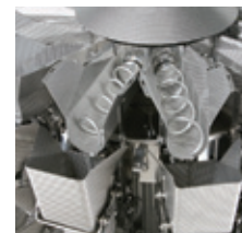
» Весовой дозатор со шнековой подачей продукта (свежее мясо)
