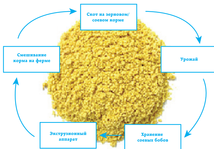
Рисунок 1. Схема получения полножирной сои по технологии сухой экструзии
