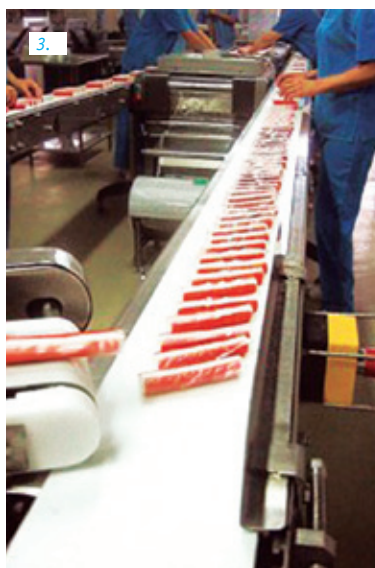
3, 4. Финальная стадия производства крабовых палочек – их упаковка. Сначала каждая палочка отдельно упаковывается в барьерную пленку, а затем – в потребительскую, как правило, вакуумную, упаковку.
