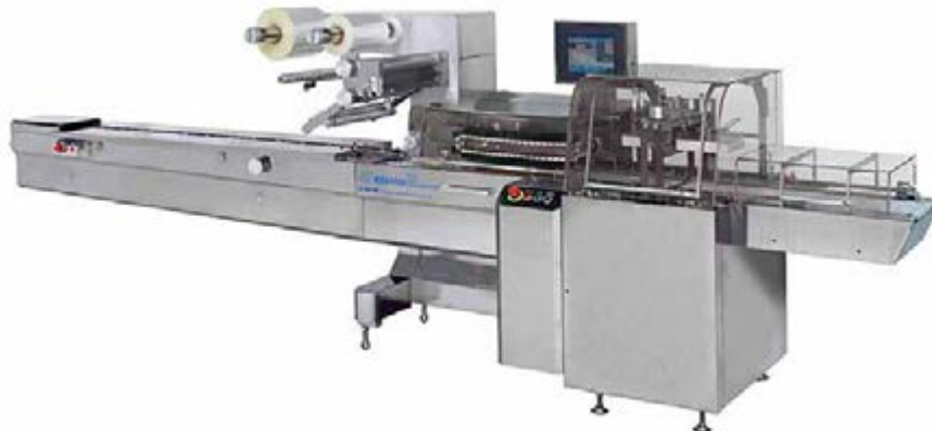
Японская фирма FUJI выпускает горизонтальные и вертикальные упаковочные машины непрерывного действия, работающие по принципу flow pack.
