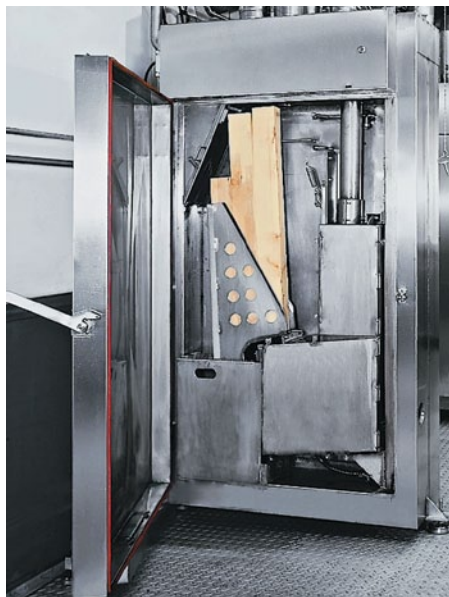
Широкое распространение в промышленности получили так называемые фрикционные дымогенераторы. Такие дымогенераторы позволяют легко регулировать режим получения коптильного дыма.
