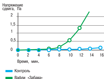
Рисунок 2. График зависимости предельного напряжения сдвига начинки от времени выстойки
