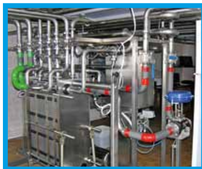
Фото 1. Пластинчатая ПЛУ на 5 т/час с подводом тепло-хладоносителей
