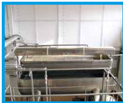
Фото 2. Автоматизированные процессы нагревания/охлаж- дения в творогоизготови- теле с прессующей ванной
