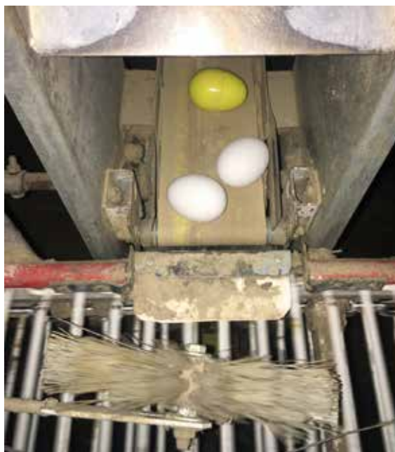
Типичный переход с ленты яйцесбора на транспортер
