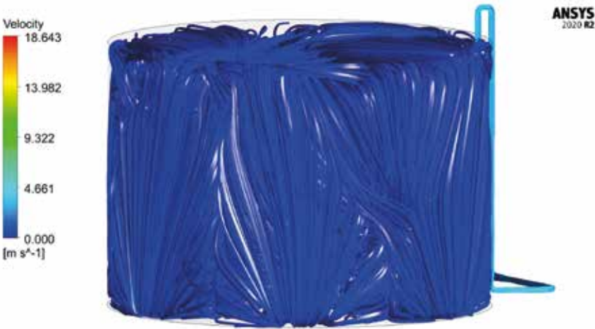
▲ Конечный результат использования программного обеспечения ANSYS для расчета оптимальных параметров устройства перемешивающего струйного УПС-ЕВНАТ
