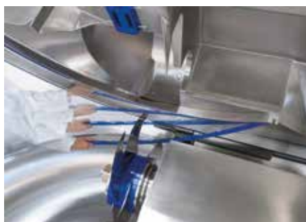
▲ Крышка-пластина с ножами куттеров Hygienic Secure разработки компании K+G Wetter в движении
