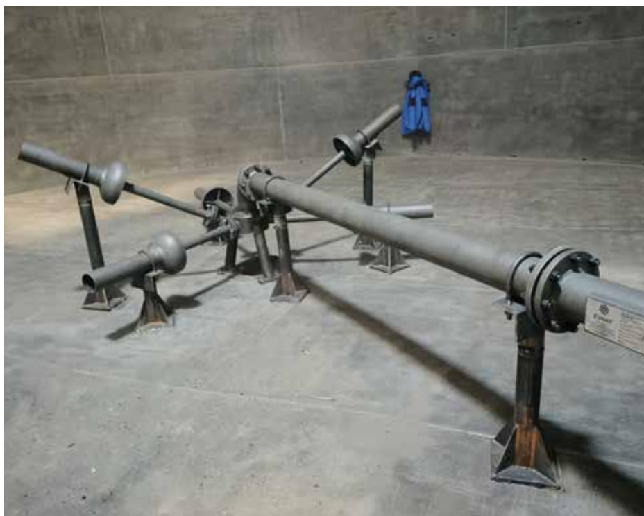
▲ Пример устройства перемешивающего струйного УПС-EVNAT
