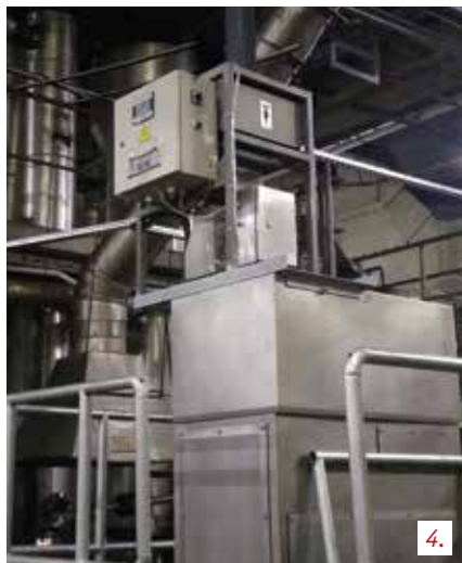
Фото 1. Конвейерный металлодетектор Erguard CM в паре с этикетировщиком на производстве мясных полуфабрикатов и готовых блюд
