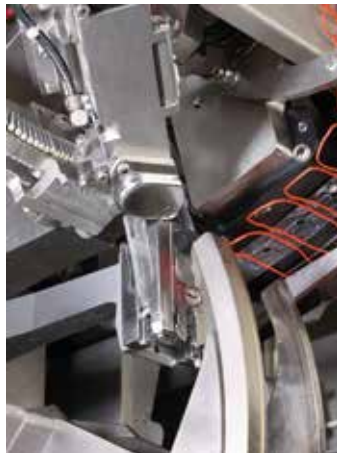
Быстрейший в мире клипсатор для U-клипов закрывает все виды колбас, таких как вареные, сырые и формовые продукты с диаметром от 45 до 160 мм.
