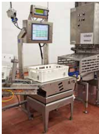
Контрольные пункты (I-пункты) являются центральными элементами в области разделки. Здесь заполненные ящики автоматически взвешиваются, а выбранный номер артикула, номер ящика и его вес объединяются между собой в системе CSB.
