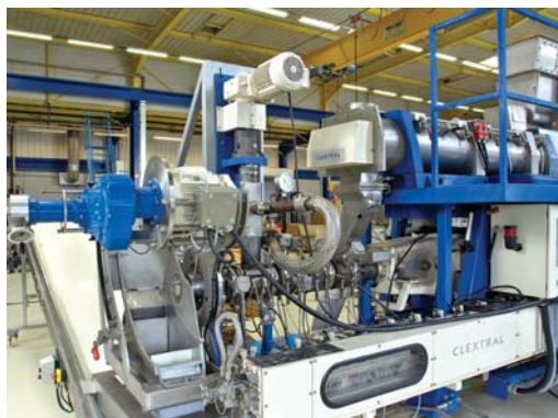
Экструдер Evolum HT 53 от Clextral обеспечивает предприятия пищевой промышленности гибким, прибыльным механизмом для обработки продуктов с высоким содержанием клетчатки и цельных зерен.
