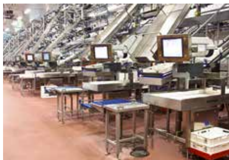
Автоматизированная упаковка мясных изделий для магазинов самообслуживания. CSB-System индицирует на мониторах заказы, включая номера артикулов, цены, срок хранения и номера партий.
