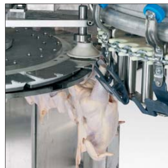
Взвешивание при перенавеске на охлаждение – высокая точность при высокой скорости
