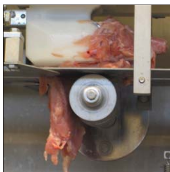
Интеллектуальная система филетирования с определением костного остатка – Бескостное филе грудки
