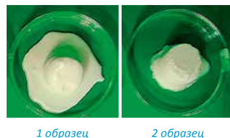
Рисунок 3. Форма порций мороженого через полчаса выдерживания при температуре 25 °С
