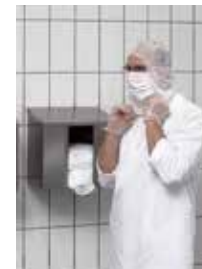
Дозатор одноразовой одежды, установленный на входе в производственный цех
