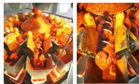
Дозаторы серии RV соответствуют стандарту IP67 и были специально разработаны для работы с такими сложными продуктами, как замороженные и свежие мясные продукты.
