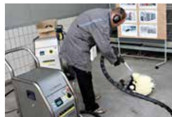
Компани Kärcher предлагает аппараты для чистки сухим льдом. Это относительно новая технология, которая применяется последние пять лет. Технология похожа на очистку песком. Преимущество состоит в том, что подобный аппарат, очищая поверхность, на выходе не оставляет ни воды, ни песка, ни каких-либо других веществ. Сухой лед – это замороженный CO 2 до температуры –80 °C, и он очень быстро переходит из твердого в газообразное состояние.
