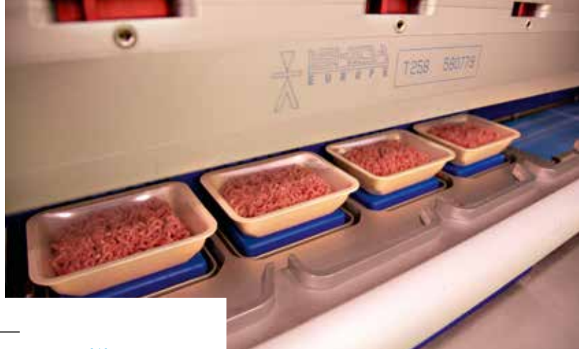
Упаковочные линии Ishida от станции заполнения лотков до запечатки в модифицированной атмосфере (температура фарша – от +3 до +5 °С).
