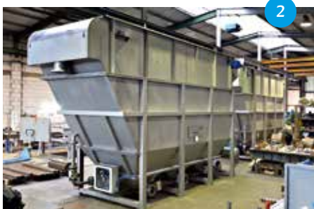
1. Модульные очистные сооружения Biomar 2. Установка флотации Flomar HL
